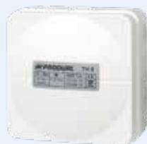
**ТН 5** — очень полезное устройство, когда выходной сигнал контроллера для нагрузки недостаточно мощный. ТН 5 — это **пусковое устройство для настенного монтажа**, которое способно запускать несколько параллельно подключенных термоэлектрических приводов. Входной сигнал пускового устройства может быть любым сигналом 5–30 В (пропорционально времени), предназначенным для регулятора термоэлектрического привода. [Стр. 127](#)
