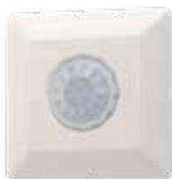
**LA 14E** и **LA 15E** — **датчики присутствия** для управления вентиляцией и освещением. Интеллектуальная, реализованная на процессоре логика предотвращает ложные срабатывания, будучи в то же время очень чувствительной. Бесшумная работа реле, регулируемая задержка при выключении. LA 15E специально разработан для управления освещением и оснащается дополнительным выходным реле для регулировки освещения. [Стр. 115](#)
