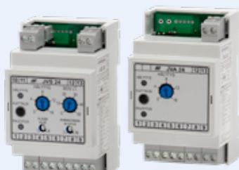
**Термостаты с защитой от замерзания JVA 24 и JVS 24** помогают защитить теплообменники в системах обработки воздуха благодаря своевременному измерению температуры и управлению клапанами. [Стр. 108](#)
