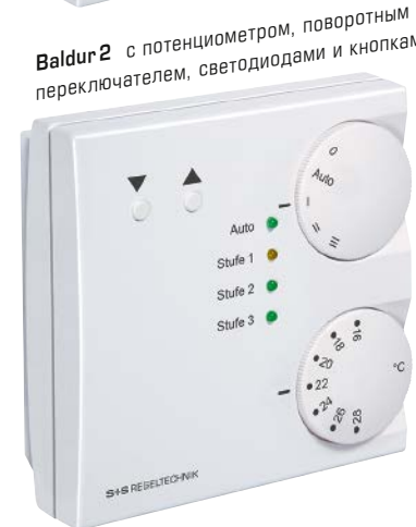
Baldur 2 с потенциометром, поворотным переключателем, светодиодами и кнопками
