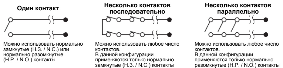
Рис. 17. Допустимые схемы соединения неконтролируемых контактов
