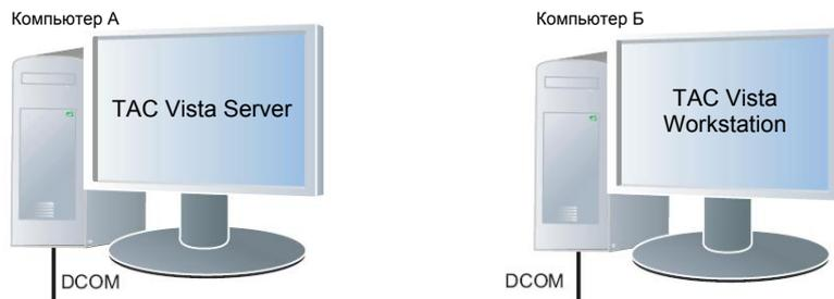
В системе с сервером Vista, установленном на одном компьютере, и Vista Workstation, установленной на другом компьютере, в Рабочей группе или не-NT домене, Вам необходимо настроить Windows Firewall для разрешения входящих коммуникаций с сервером Vista. Вам также необходимо изменить настройки безопасности COM для возможности коммуникаций по сети.
