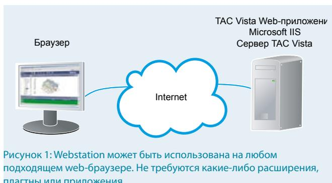
Рисунок 1: Webstation может быть использована на любом подходящем web-браузере. Не требуются какие-либо расширения, плагны или приложения.
