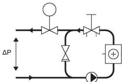
В. Схема с локальным циркуляционным насосом.
