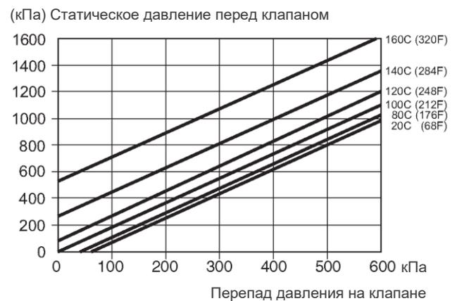
Граница перепада давления, на которой может произойти кавитация, зависит от давления на входе клапана и температуры воды.
