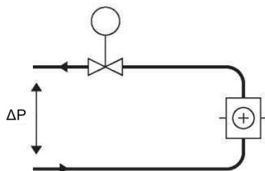
А. Схема без локального циркуляционного насоса.
